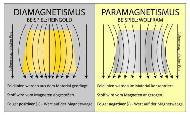
Ein **paramagnetisches Material** wird dagegen nur **sehr schwach** von einem Magneten **angezogen**. Es wird also ein starkes äußeres Magnetfeld benötigt, um einen merklichen Effekt zu erzielen.
